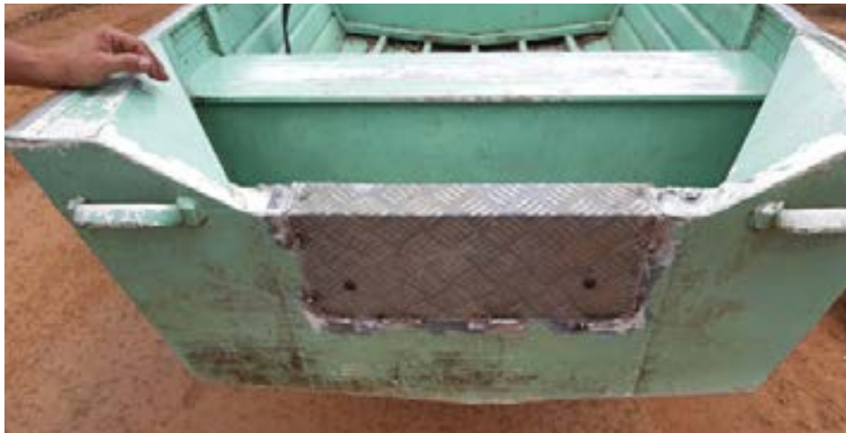
Manutenção (solda de uma chapa de alumínio) da embarcação de 7,0 m da aldeia Traíra (IEB890) realizada na oficina na cidade de Humaitá –AM.
