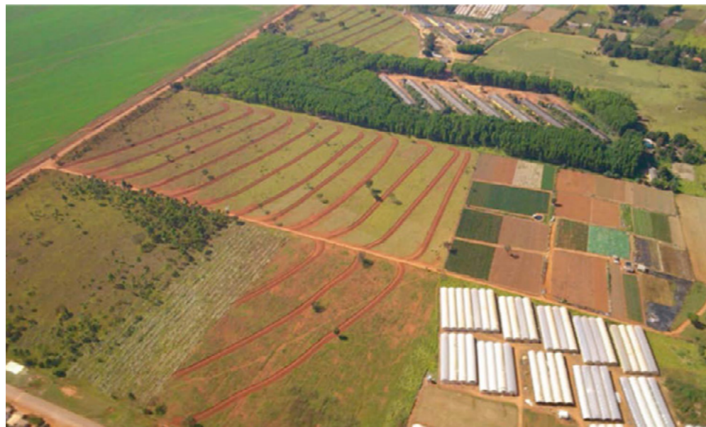
Figura 32. Imagem aérea do terraceamento em nível (acervo da ANA). Fonte: Lima e Ramos (2018)
